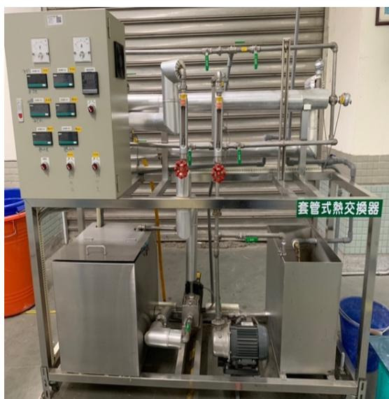
套管熱交換器
